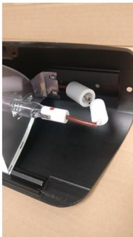
5. Trennen Sie beide Flachsteckverbindungen.
