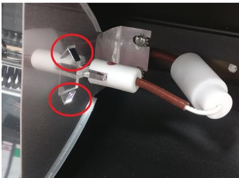
b) Ziehen Sie die kleinen Reflektorplatten aus dem Reflektor.
