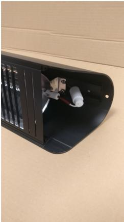
2. Entfernen Sie das Glaskeramikmodul. Lösen Sie dafür die 4 Schrauben, die das Glaskeramikmodul mit dem Gehäuse verbinden.
