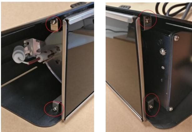
3. Entfernen Sie auf beiden Seiten des Reflektors die kleinen Reflektorplatten, die sich direkt vor der Heizröhre befinden und die Heizröhre in Schlitzn fixiert.
