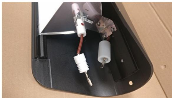
6. Ziehen Sie die Heizröhre aus dem Reflektor.
