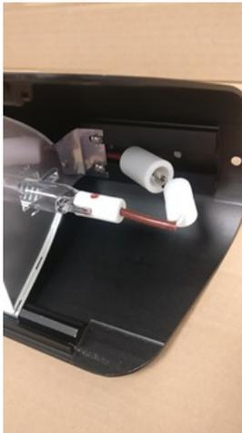
5. Trennen Sie beide Flachsteckverbindungen.
