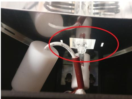
4. Öffnen Sie auf beiden Seiten die weißen Gehäuse der Flachsteckverbindungen.
